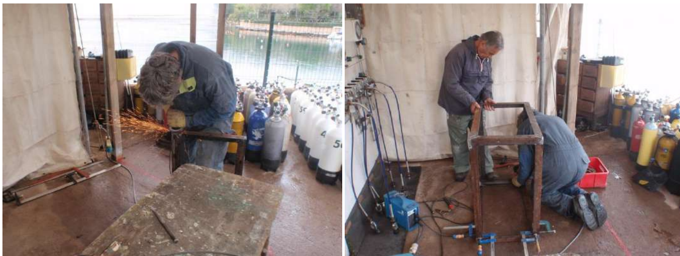
Les ateliers soudure, meulage, présentations des fers.
